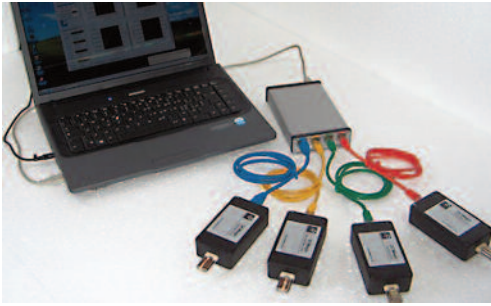
Quartz Crystal Microbalance multicanale, per misure in aria e in liquido, completa di camere di misura statiche e a flusso
